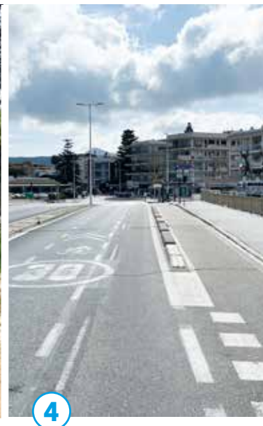
1. De geldende snelheidslimieten zijn nauwelijks uit het wegbeeld af te leiden. 2. Communicatie over aanwezigheid fietsers 3. Bord passeerafstand 4. Keuzevrijheid voor fietsers door 'fietsstrook' naast een vrijliggend fietspad
