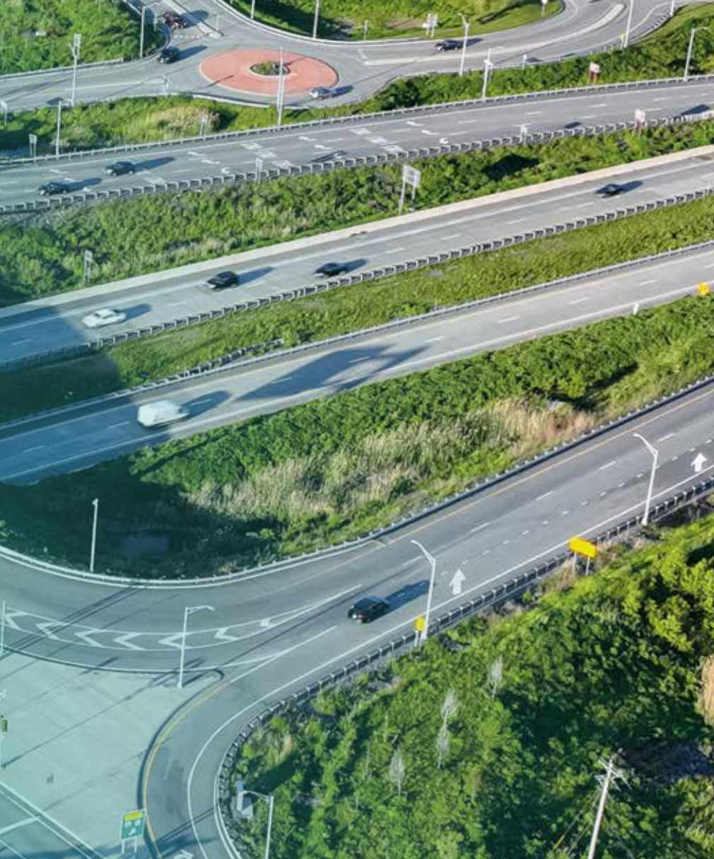
Bij DDI, Diverging Diamond Interchange, wisselen de rijrichtingen op een kruispunt tijdelijk van kant
